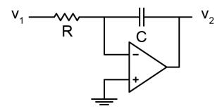
$$v_2 = -\frac{1}{RC} \int v_1(t) dt$$
